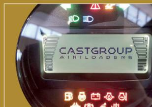
Écran électronique avec voyants qui indiquent les anomalies, le moteur, la jauge d'huile hydraulique et le système de flottement électrique.
