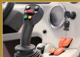
Joystick à 5 et 11 fonctions. Le joystick à 11 fonctions est de série sur LX.
